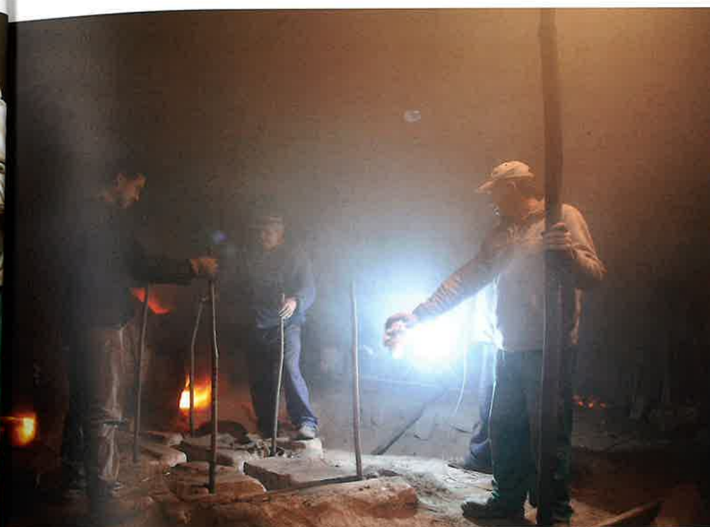
O mestre dando as instrucións previas a golpear o tapón do crisol, para saír o metal fundido
