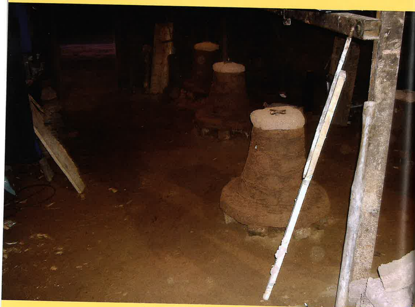
Moldes interiores ou machos dispostos debaixo da viga de ferro, na que se suxeitaron os eixes e os patróns
