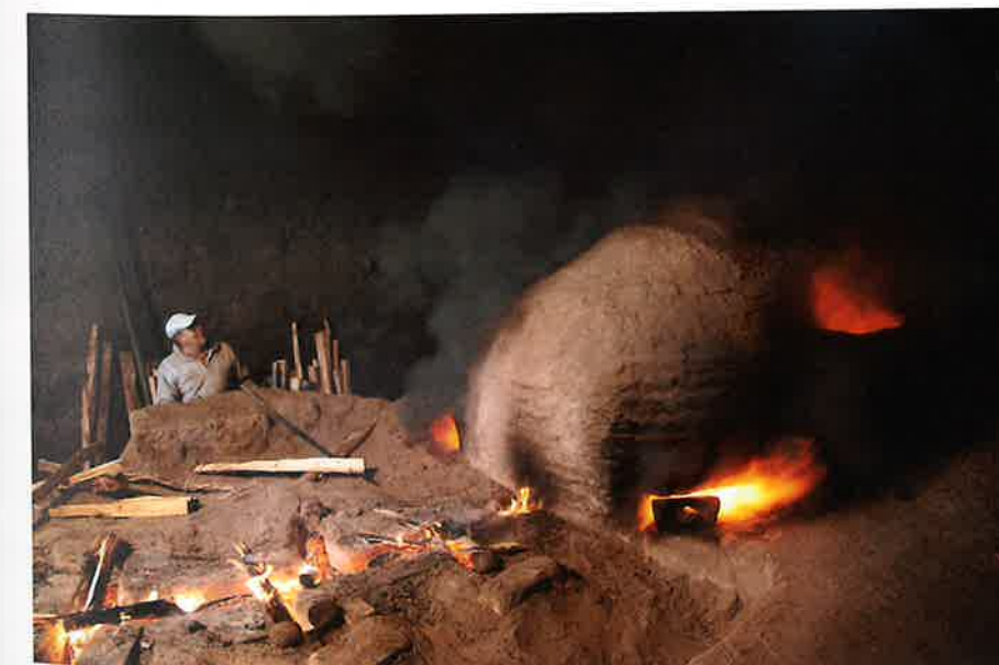
O mestre Enrique controlando a fundición do metal e o lume sobre as canles
