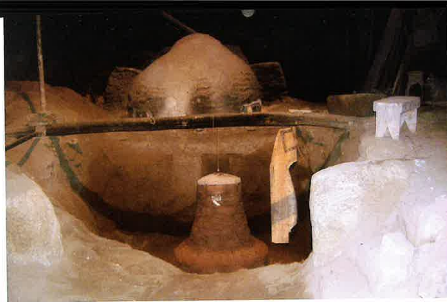
Molde interior co patrón ó lado na trinchera de diante do crisol
