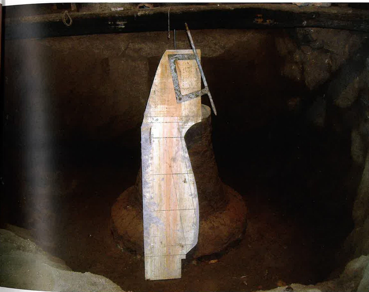
O patrón diante do molde interior ou macho na trincheira de diante do crisol
