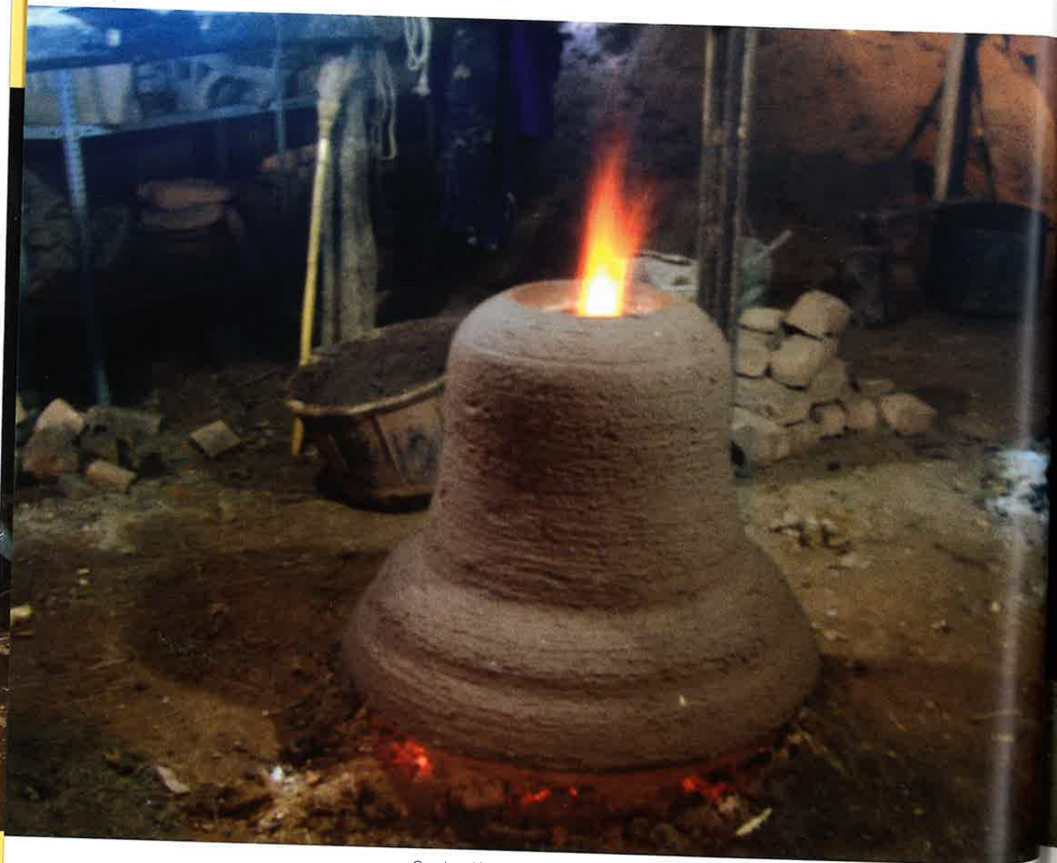
Combustión dentro do molde para o seu secado
