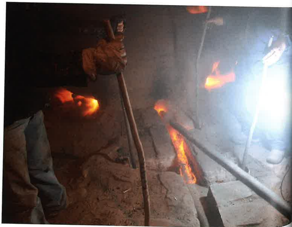
O mestre golpea co varal o tapón do crisol e comeza a saír o metal fundido
